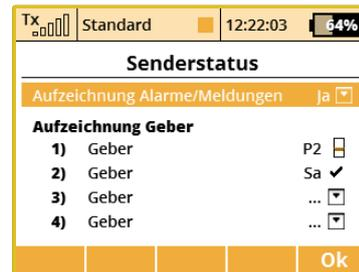
In diesem Menü können auch bis zu vier Geber und deren Position in einer Datei auf der SD-Karte gespeichert werden. Es ist möglich, zwischen der Aufnahme proportional oder Zwei-Zustands-Werten (0% - 100%) zu wählen. Die Positionen der Bedienelemente sind mit einem festen Intervall von 0,2s aufgezeichnet.
