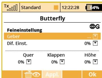
Im letzten Bildschirm des Butterfly-Menüs können Sie die Feinabstimmung aller Klappenwege durch einen Geber (Steuerknüppel, Drehknopf, Schieber oder Schalter) beeinflussen. Die Werte, die Sie in dieser Form eingestellt haben, werden addiert/subtrahiert zu den entsprechenden Klappenwegen in der Butterflyposition.
