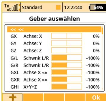
Die Parameter **"Achse X «"** und **"Achse X »"** repräsentieren virtuelle Schalter mit zwei Zuständen. Diese werden aktiviert, wenn der Sender nach links oder nach rechts entlang der X-Achse geneigt wird.
