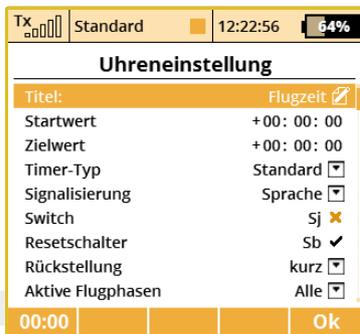
Mit der Taste "F3(edit)" oder der "3D-Taste" rufen Sie die Konfiguration der mit dem Cursor markierten Stoppuhr auf.
