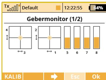
Dieser Gebermonitor bietet eine Darstellung der aktuellen Positionen aller Proportionalgeber und Schalter. Ebenso können in diesem Menü die Proportionalgeber kalibriert werden, als Hilfestellung wird der Ablauf interaktiv unterstützt – sie erhalten entsprechende Hinweise am Senderdisplay.
