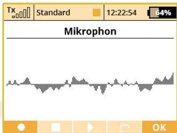
Die Mikrofonfunktion gibt Ihnen die Möglichkeit auch eigene Ansagen zu erstellen. Die haben eine maximale Länge von 10 Sekunden und werden als **"single-track wav"** Datei (11025Hz Abtastrate) abgespeichert.
