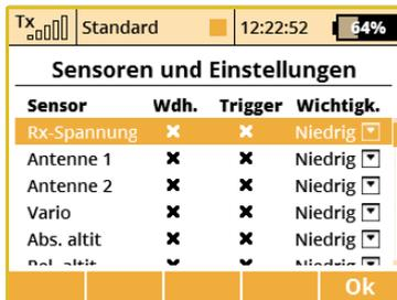
Die zweite Option ermöglicht es, Daten nur einmal, nach einer einzigen Betätigung des Trigger-Schalters, anzusagen. Der Trigger-Schalter und die Telemetriewerte können selbst gewählt werden.
