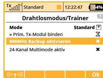
Das 900MHz Backup-System kann zusätzlich zu den bekannten HF Optionen der JETI Duplex Sender genutzt werden. So wird eine maximale Redundanz und Sicherheit durch den Einsatz sehr unterschiedlicher Frequenzbereiche erreicht. In dem Menüpunkt **"Drahtlosmodus/Trainer"** setzen Sie dazu den Haken bei **900MHz Backup aktivieren setzen**. Das Binden des 900MHz Rsat erfolgt auf die gleiche Weise wie bei den herkömmlichen Duplex 2,4GHz Empfängern.
