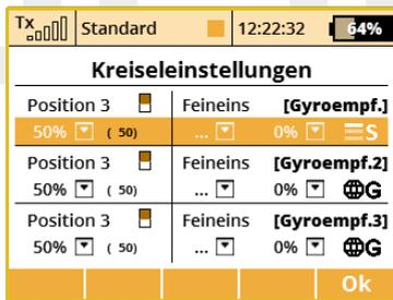
In der Ausgangskonfiguration des Modells ist für die Auswahl der Kreiselempfindlichkeit der Dreiweg-Schalter "Si" vordefiniert. Die Konfiguration der drei möglichen Schalterpositionen erfolgt mit den Parametern "Position 1", "Position 2" und "Position 3". Durch Ein-
