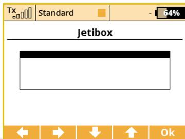
Aus Gründen der maximalen Kompatibilität mit dem DUPLEX System der I. Generation ist der Sender mit einer Emulationsfunktion der JETIBOX ausgestattet. Das DUPLEX 2,4GHz - Menü wird in der bekannten zweizeiligen Darstellung abgebildet. Mit den Funktionstasten bewegen Sie sich analog zu den Tasten der Jetibox im Menü um die einzelnen Parameter ansehen und/oder ändern.
