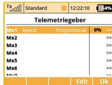
Bis zu 16 Geber mit der Bezeichnung **MX1 – MX16** sind (**abhängig vom Sendertyp**) verfügbar. Die Telemetriegeber können in zwei verschiedenen Modi programmiert werden:
