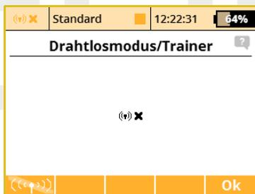
Sie können das **HF-Modul** manuell deaktivieren um die Abstrahlung der internen Sendemodule zu unterdrücken. Drücken Sie dazu die **“F1” Taste** unterhalb des Bildschirms und bestätigen diese Eingabe). Das Sendemodul schaltet sich außerdem automatisch ab, wenn der USB-Anschluss aktiviert wurde.
