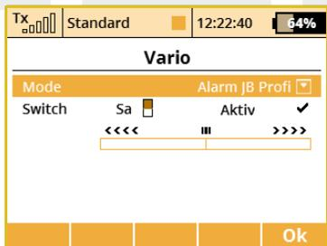
Die zweite Option der Varioakustik ist für EX-Sensoren geeignet. Die akustische Signalisierung variiert in direkter Abhängigkeit von den
