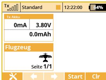
4. **"Antenne"** - Information über die Signalstärke. Der Prozentsatz der korrekt ausgeführten bidirektionalen Kommunikation zwischen Sender und Empfänger (0-100%) wird auch in dieser Box des Antennenlevels angezeigt.
