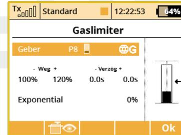
Wenn Sie mehrere Flugphasen programmiert und diesen jeweils eigene Gaskurven zugewiesen haben kann die Drehzahl im gesamten Bereich von der geringsten bis zur höchsten durch den Gaslimiter im zulässigen Bereich gehalten werden.
