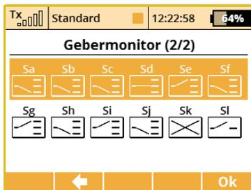
Mit der Taste "F3()" wechseln Sie zum Menü "Gebermonitor (2/2)" welches die ausgewerteten Positionen der Umschalter darstellt. Durch Auswahl und Editieren eines der Umschalter gelangen Sie in das Menü "Sticks/Schalter Setup". Die Bezeichnungen **Sk** und **Sl** sind für Knüppelschalter/-taster reserviert.
