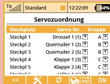
**Notiz:** Um die Servowege über den Servobalancer zu optimieren, empfehlen wir ein Amperemeter oder einen MUI-Sensor mit Telemetrie-Fenster (anstatt der Uhrzeit des Senders einblenden) im Empfängerstromkreis. Man kann so die geringst mögliche Stromaufnahme der Servos zu justieren.
