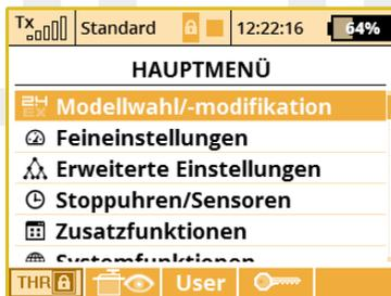
**Notiz:** Benutzen Sie die Funktion der Gasverriegelung immer dann, wenn Sie an einem Modell hantieren und die Gefahr besteht, dass bei einer ungewollten Betätigung des Gebers für die Motorsteuerung ("Gasknüppel") der Motor anläuft!
