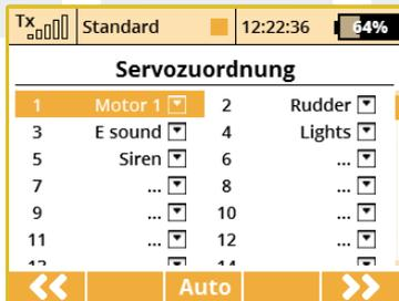
**Notiz:** Standardmäßig wird der Sender nur die ersten 16 Kanäle verwenden. Weitere Kanäle werden automatisch eingeschaltet, sobald Servos den Kanälen 17-24 zugeordnet werden. Sie können den "24-Kanal Multi-Modus" Status in Erweiterte Eigenschaften » Drahtlos-Modi/Trainer kontrollieren.
