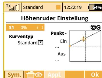
Im dritten Bildschirm können Sie eine Kurve für den Höhenruderausgleich setzen. Sie können zwischen einer Standard-Kurve, einer Konstante und X-Punkt-Kurve-Typen wählen.
