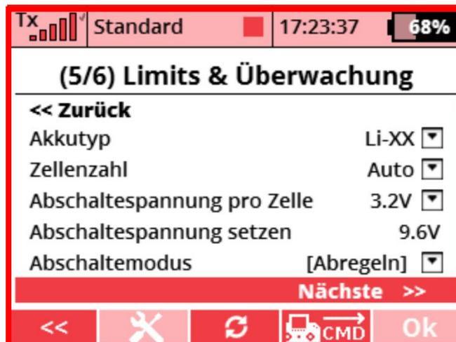
**Zellenzahl** - mögliche Einstellung von 2-12 Zellen oder "Auto". Der automatische Modus erkennt die Anzahl der Zellen und der Controller bestimmt ihre Anzahl entsprechend der Spannung des angeschlossenen Akkus.
