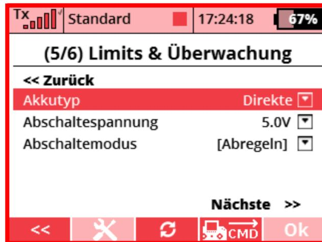
**Abschaltespannung** – Direkteingabe der minimalen Akkuspannung. Bei dieser Grenze wird der Akkuschutz aktiviert. Der einstellbare Bereich beträgt 5-40V.
