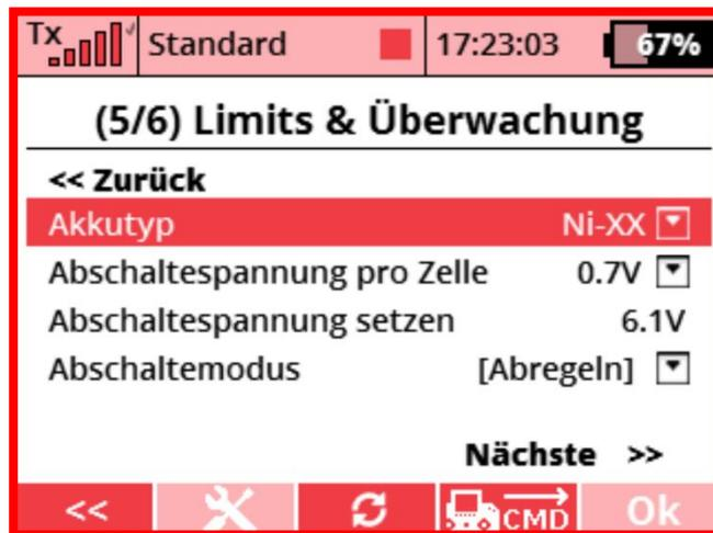
**Abschaltspannung pro Zelle** – Einstellen des minimalen Spannungswerts pro Zelle des Antriebsakkus. Bei dieser Grenze wird der Akkuschutz aktiviert. Die Werkseinstellung ist 0,7 V.
