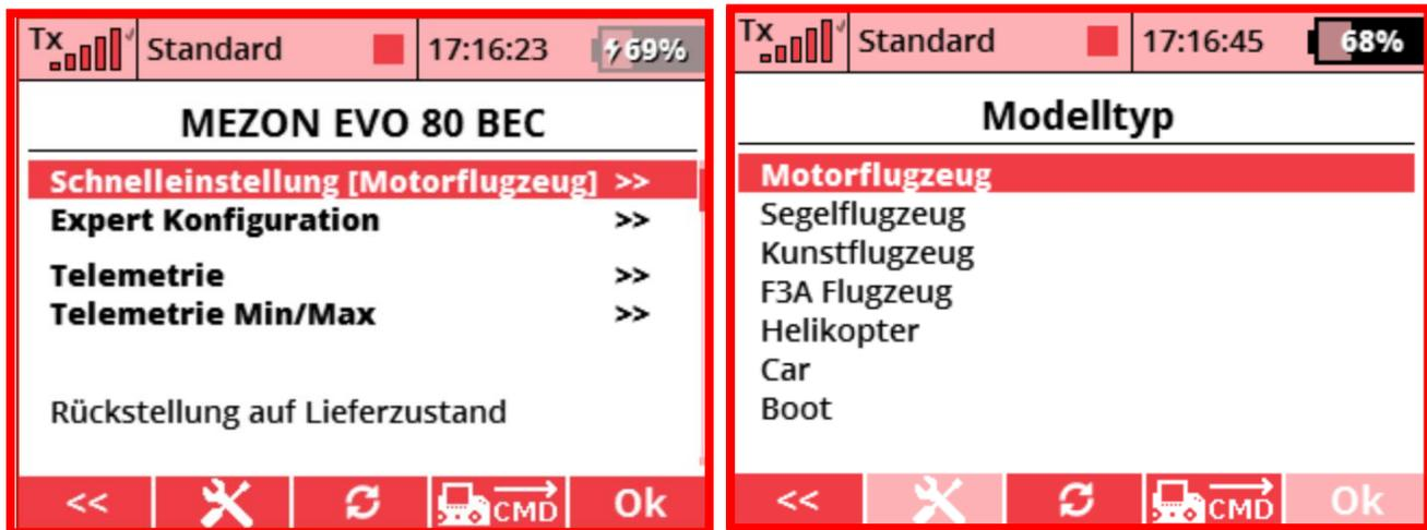
Wählen Sie auf dem nächsten Bildschirm den genauen Typ des Modells aus. Je nach gewähltem Modelltyp werden die Reglerparameter automatisch auf optimale Werte voreingestellt. Detaillierte Werte finden Sie bei Bedarf in der Tabelle am Ende des Handbuchs.
