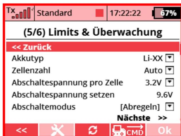
**Akkutyp** – Wählen Sie entsprechend der Art der Antriebsakkus. Verfügbare Optionen sind „Ni-XX“ (NiMH- oder NiCd-Akkus), „Li-XX“ (Li-Ion- oder Li-Po-Akkus) oder vom Benutzer frei einstellbare Werte im „Manuell“-Modus.
