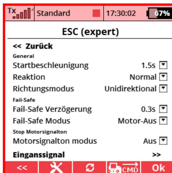
**Hinweis:** bei Flugmodellen: Je größer der Propeller, desto länger muss die Beschleunigungszeit eingestellt werden. Verwenden Sie außerdem für einen großen Außenläufermotor eine Beschleunigungszeit von 2 Sekunden oder mehr. Eine zu schnelle Einstellung der Beschleunigung bei großen Motoren und großen Propellern führt zu großen Anlaufströmen, die zu Schäden am Regler führen können.
