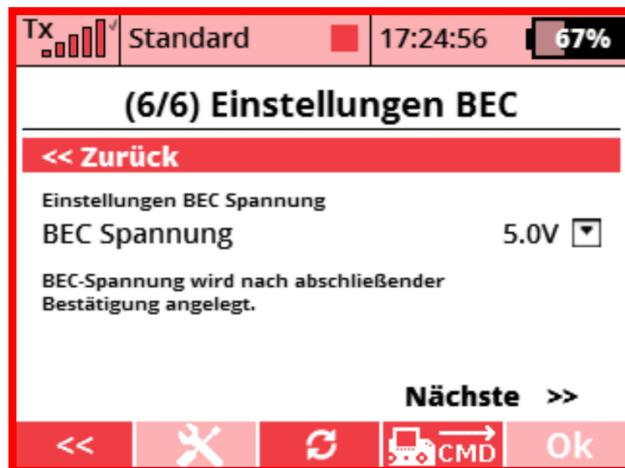
Der einstellbare Spannungsbereich des BEC beträgt 5-8,4V. Aus Sicherheitsgründen wird die Änderung des BEC-Spannungswerts erst nach der abschließenden Bestätigung der gesamten Reglereinstellung auf dem folgenden Bildschirm aktiviert.
