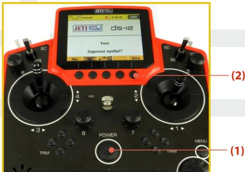
\* Si no confirma el encendido en un cierto límite de tiempo, la emisora se apagará automáticamente. Mediante su ajuste puede desactivar la confirmación en el menú **"Menu Principal->Sistema->Configuracion->Desactivar pregunta al inicio"**.
