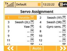
7. El menú "Asignación de Servos" muestra las salidas del receptor y su asignación a las salidas de la emisora. Si necesita cambiar cualquiera de las asignaciones de salida, seleccione el canal que desea editar y reasigne su salida. Pulse „F5(Siguiente)" para confirmar.
