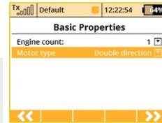
5. El primer ítem a ajustarse en "Propiedades Básicas" es el número de motores del modelo. En este ejemplo, este ítem no se modifica y se pasará al siguiente, en el cual se elige el tipo de control del motor – p.e. si el motor gira en una sola dirección o en ambas. Edite el ítem "Tipo motor" y seleccione "Dos direcciones". Pulse el botón "F5(Siguiente)" para confirmar.
