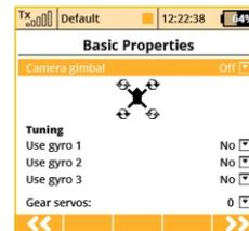
5. Elija las propiedades básicas de su multicóptero, gimbal de cámara (desactivado, un eje o tres ejes), número de funciones de ajuste de giróscopo y servos de tren.
