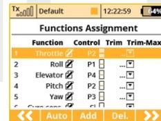
6. El menú "Asignación de Funciones" lista las asignaciones de las funciones a sus interruptores/sticks. Si necesita cambiar las asignaciones de interruptor/stick, seleccione el ítem "Control" para la función de vuelo deseada y elija el interruptor/stick que desee. Pulse "F5(Siguiente)" para confirmar.
