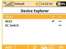
Básicamente, Device Explorer (que se encuentra en el menú Model) reemplaza la emulación de la Jetibox y ofrece adicionalmente una forma más inteligente de comunicarse con su dispositivo. La pantalla principal de Device Explorer
