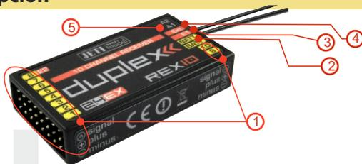
1. Los receptores JETI Duplex utilizan conectores de servo universal o "tipo JR"
