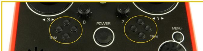
Los trims digitales se utilizan para realizar un ajuste fino del modelo. Cuando la emisora se apaga, los valores del trim se guardan en memoria y se cargan cuando el sistema se enciende de nuevo.
