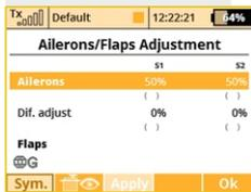
c. En la primera línea de menú pulse el "Selector 3D", elija "Interruptor" y pulse el "Selector 3D" de nuevo. Después mueva la "leva derecha(5)". Confirme con el botón "F5(OK)". El último paso es elegir la cantidad de movimiento de los alerones para al hacer de spoiler (o flap) y elegir la compensación de elevador deseada.
