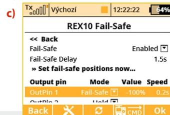
salida en caso de pérdida de señal. Si utiliza el modo Hold, se mantendrá la última posición conocida del servo. La opción Out Off significa que no habrá señal de salida de un canal en particular. La última opción, Fail-Safe, moverá el servo a la posición definida por el usuario en la columna "**Value**".
