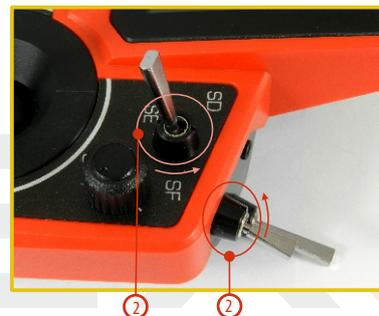
3. Sujete el interruptor por la parte trasera de la emisora y tire de él para extraerlo de la estructura de la emisora.
