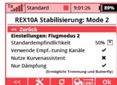
**Heading Hold** - Die eingeleitete Flugrichtung wird so weit wie möglich eingehalten wird, z.B. im Messerflug eines Kunstflugmodells. Verwenden Sie den Heading Hold-Modus bei Flächenmodellen nicht bei Starts oder Landungen, da bei niedrigen Geschwindigkeiten die Gefahr eines Überziehens besteht.
