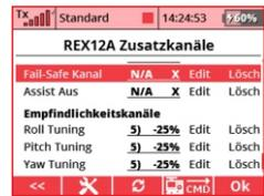
**Hinweis:** der angezeigt % Wert besagt, um wieviel die gesetzten Werte der Stabilisierung (unter Flugmodus/Stabilisierung > Flugmodus > Edit) erhöht oder niedriger werden.
