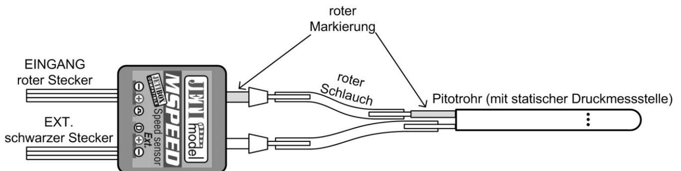
Das Basisgerät des Sensors MSPEED enthält weiterhin zwei dreiadrige Kabel. Das eine ist mit „INPUT“ bezeichnet, das andere mit „EXT“. Der mit „INPUT“ bezeichnete Leiter überträgt das Steuersignal, nach dessen Zustand sich die akustische Signalisation des MSPEED Sensors richtet. Der mit „EXT.“ bezeichnete Leiter überträgt Daten zwischen dem Sensor und dem DUPLEX-System oder der JETIBOX .
