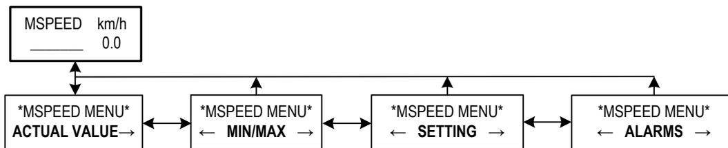
Durch Drücken der Taste D (nach unten) an der JETIBOX betreten Sie das Menü MSPEED.
