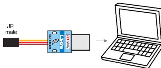
2. installieren Sie den Treiber des USB-Adapters, den Sie auf den Internetseiten von [www.jetimodel.com](http://www.jetimodel.com) finden, oder der Ihnen auf den Internetseiten zur Verfügung steht: <http://www.ftdichip.com/Drivers/D2XX.htm>. Bei neueren Versionen von Betriebssystemen werden die Treiber automatisch heruntergeladen und installiert.
