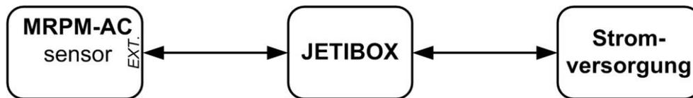
2. Schließen Sie das dreiadrige Kabel des Moduls MRPM-AC mit JR-Stecker an die Buchse des Empfängers an seiner Rückseite an (Bezeichnung Ext.). Das Modul MRPM-AC wird vom Empfänger mit Strom versorgt. Zur Parametereinstellung des Moduls MRPM wird die JETIBOX an das Sendermodul angeschlossen und der Empfänger sowie Sender DUPLEX eingeschaltet.
