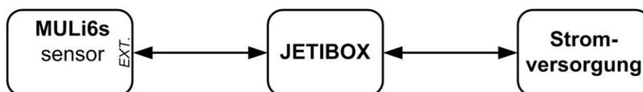
2. Schließen Sie das dreiadrige Kabel des Sensors MULi6s mit dem JR-Stecker an die Buchse an der Hinterseite des DUPLEX-Empfängers mit der Bezeichnung Ext. an. Der Sensor MULi6s wird hierbei vom Empfänger versorgt. Zur Parametereinstellung des Sensors MULi6s schließen Sie die JETIBOX and das Sendermodul an und schalten den DUPLEX-Empfänger und Sender ein.
